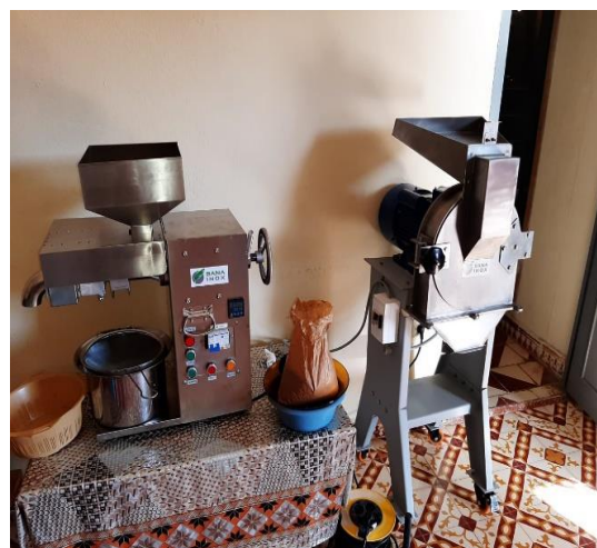
Figure 4. Équipements de transformation des fruits secs (broyeur et extracteur d'huiles) fournis par l'ONCA à la coopérative « Mssala » en 2022
